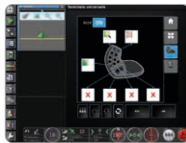
Assegnazione AUX-N: a seconda delle caratteristiche è possibile assegnare fino a 10 funzioni sul bracciolo e altre 9 sull'iMonitor.
