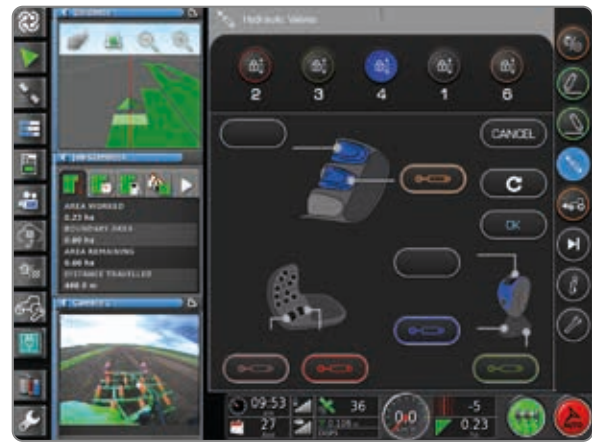
Distributori - È possibile cambiare l'ordine dei distributori, oltre a portata e regolazione dei tempi.
