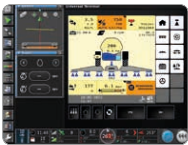
Indipendentemente dal profilo dell'applicazione – tutti gli attrezzi ISOBUS vengono visualizzati attraverso l'Universal Terminal di iMonitor.
